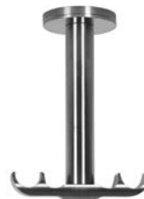
Durchschleuderträger 1-läufig für Wandmontage Abstand Wand bis Stangenmitte 5 cm, 10 cm oder 15 cm Grundplatte D = 42 mm, Trägerstab D = 18 mm, mit 3 verdeckten Montagebohrungen 5 cm: Art. Nr. T-5220 10 cm: Art. Nr. T-5221 15 cm: Art. Nr. T-5222
