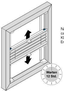
Nach Montage der Klebeleisten ca. 12 Stunden warten, bis die Klebeverbindung optimalen Halt bietet. Erst dann kann die Anlage bedient werden.
