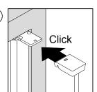
Montieren Sie die Anlage so, dass die sichtbaren Magnete nach oben zeigen. Spannfüße rasten hörbar ein.
