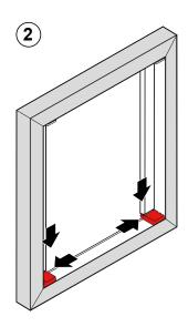
Zum Finden der Montageposition, Schiene nach links unten bis Anschlag schieben.
