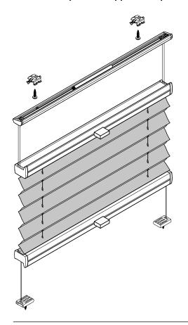
Beim Öffnen Produkt nicht mit scharfem Messer beschädigen! Schrauben-Montage: Torx Biteinsatz TX15.
