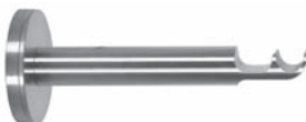
Durchschleuderträger 1-läufig für Wandmontage Abstand Wand bis Stangenmitte 5 cm, 10 cm oder 15 cm Grundplatte D: 42 mm, Trägerstab D: 14 mm, mit 3 verdeckten Montagebohrungen 5 cm: Art. Nr. D-6220 10 cm: Art. Nr. D-6221 15 cm: Art. Nr. D-6222
