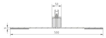
Standfüße mittels der mitgelieferten Schrauben an das Sonic-Panel montieren.
