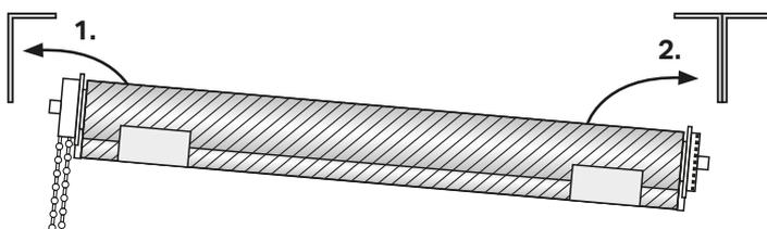
Zur Montage u. Demontage des Rollos transparentes Kunststoffrad drehen.
