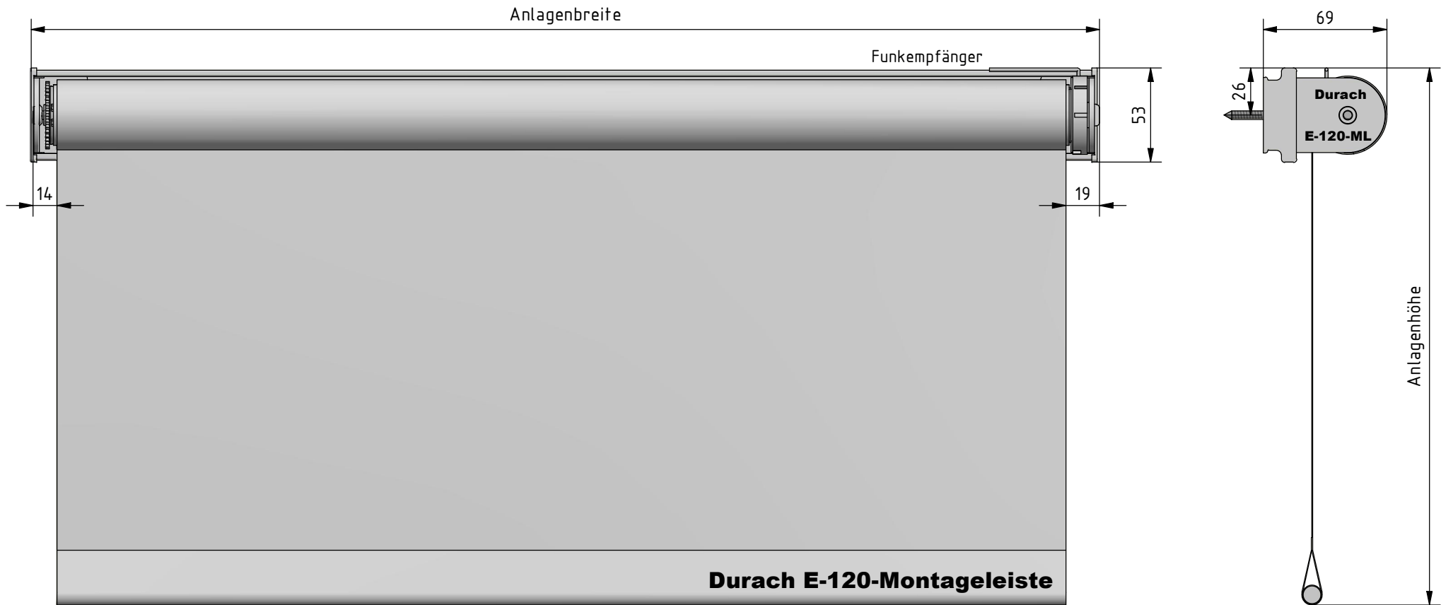
Montage: Montageleiste mit Durchgangsbohrungen
