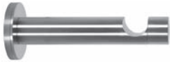
Träger 1-läufig Abstand Wand bis Stangenmitte 5, 10 oder 15 cm Grundplatte D = 46 mm, Trägerstab D = 22 mm, mit 3 verdeckten Montagebohrungen 5 cm: Art. Nr. V-4210 10 cm: Art. Nr. V-4211 15 cm: Art. Nr. V-4212
