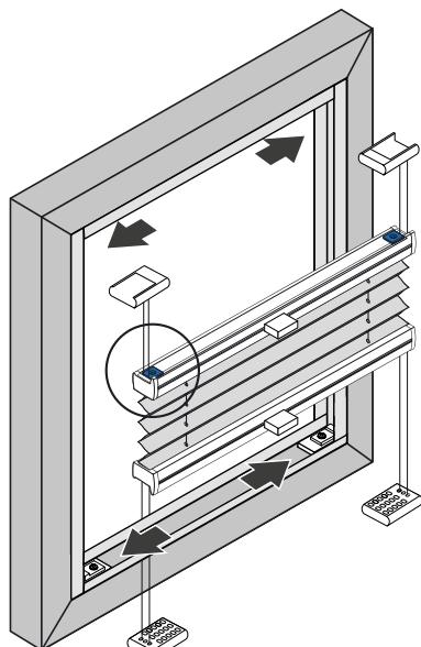
Montieren Sie die Anlage so, dass die sichtbaren Magnete nach oben zeigen.
