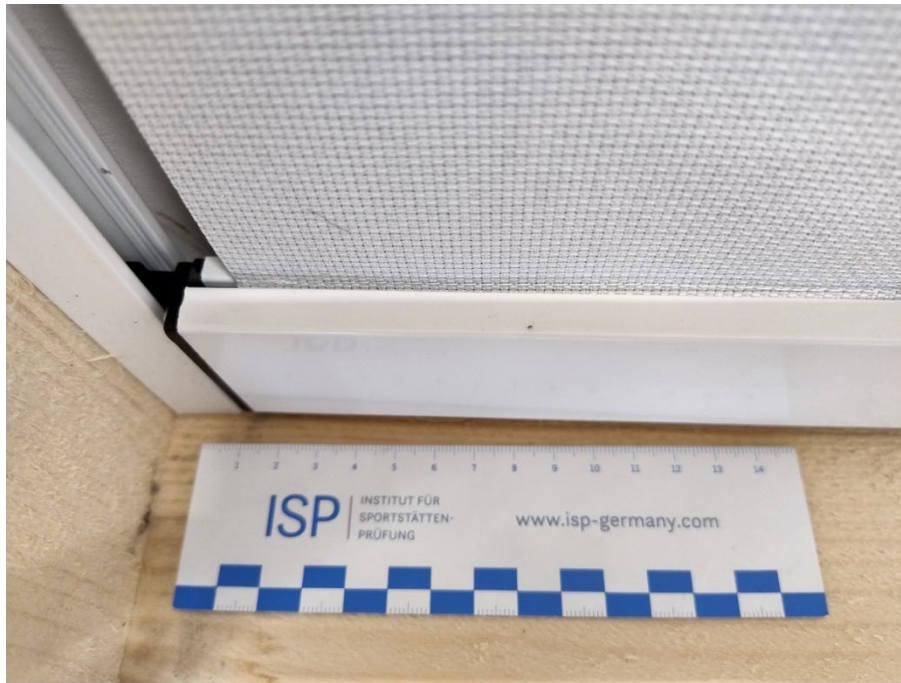
Bild 3: Nahansicht des Fallstabes im Rahmen
