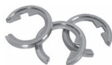
Durchschleuderring 25 mm mit Gleiteinlage, inkl. Überstülphaken Durchmesser außen: 25 mm Durchmesser innen: 18 mm
